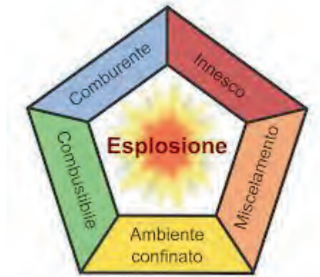
Figura 26: Il “pentagono” dell'esplosione
